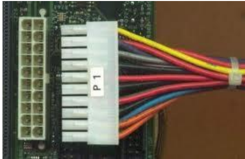
Conector hembra y macho ATX de 20 pines
